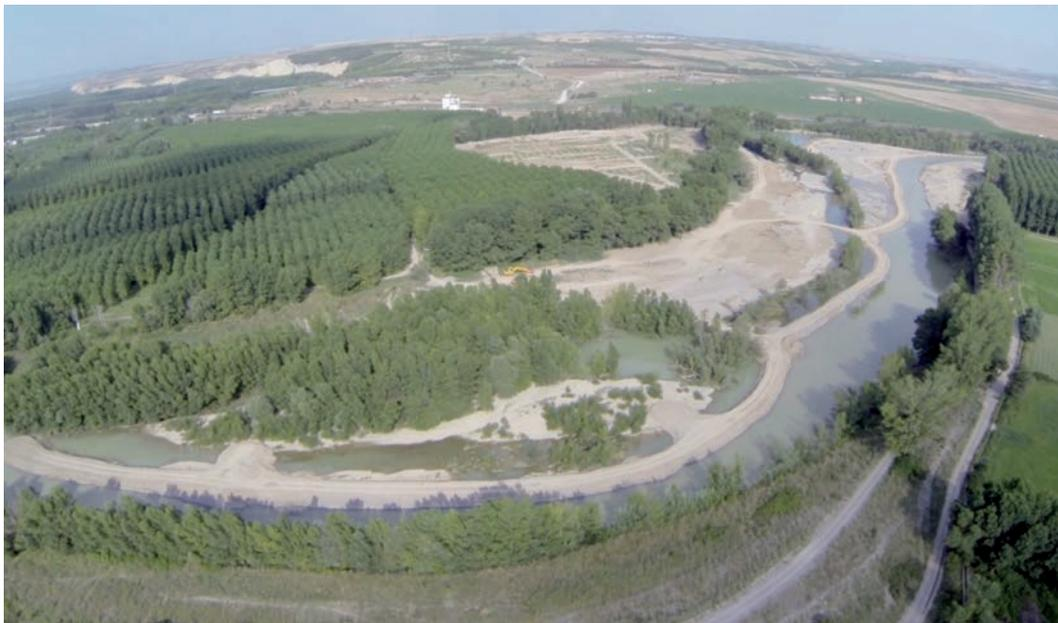
Imagen área de la zona de Sotoconttiendas aún en obras, y con el cauce del Aragón aún desviado y ocupado parcialmente por grandes ataguías para el transporte de materiales. En la foto superior de portada puede observarse la zona en crecida, con el río ocupando todo el espacio libremente.
